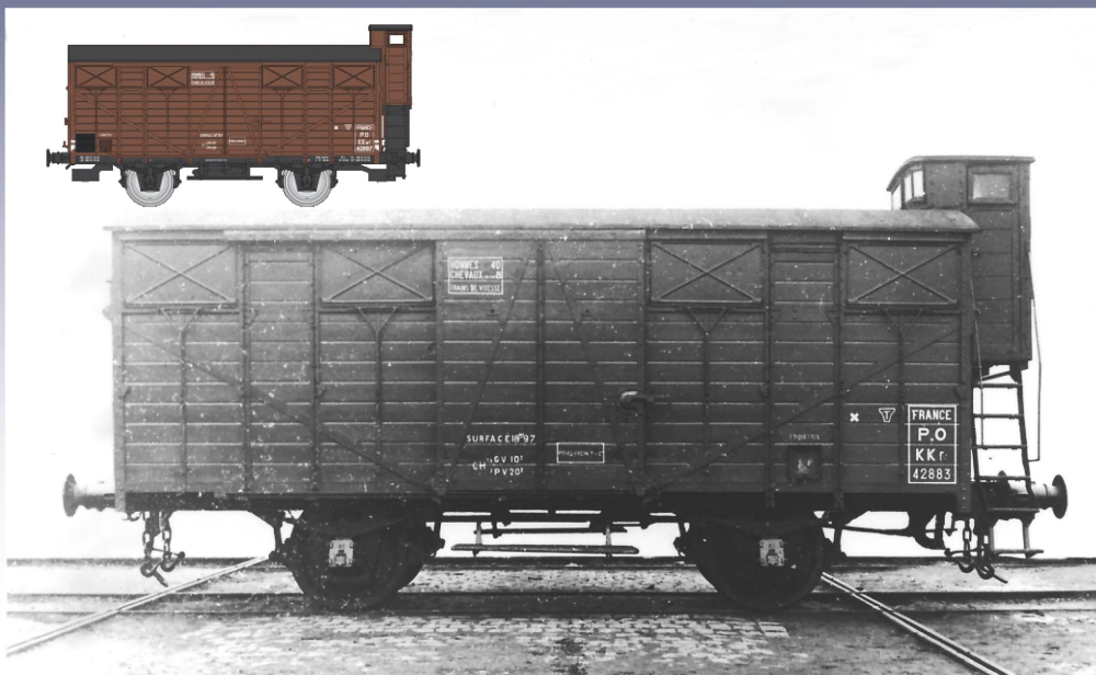
Wagon couvert type unifié 1919 de l'OCEM. La teinte générale est foncée, témoignant du brun PO N°2. Cliché DR, collection J. Willigens.
